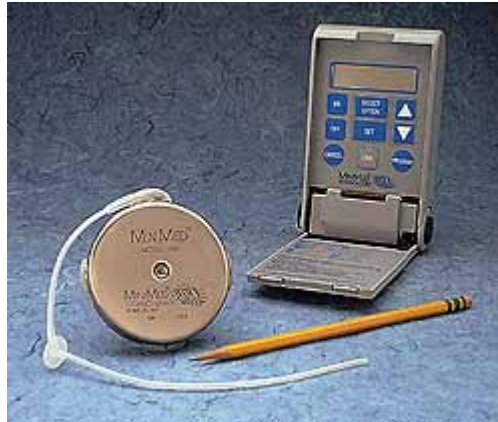
شکل ۴-۱. یک پمپ کاشتنی رهایش انسولین ساخت شرکت Minimed که شامل مخزن دارو و پمپ است. یک مداد جهت مقایسه ابعاد نشان داده شده است. ۱۷
