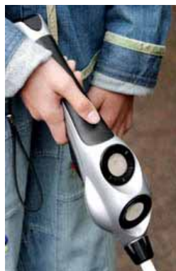
شکل (۳-۳۵) - عصای Ultracane برای نابینایان که بر مبنای صوت کار می‌کند.
