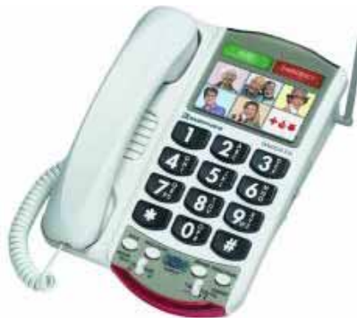
شکل (۱۱۲-۳) - تلفن با صفحه کلید بزرگ و عکس ، که با لمس عکس آنها شماره‌گیری می‌کند ۲ .
