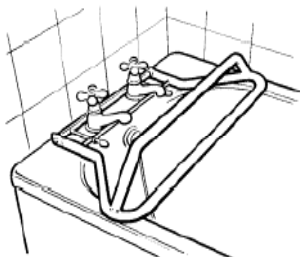
تصویر ۵۱-۲: تصویر مقابل چگونگی اتصال دستگیره‌های کمکی متصل به شیر در وان را نشان داده است. مأخذ: www.elderoptionsflexas.com
