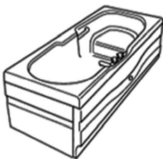
تصویر ۳۳-۲: نمونه‌ای از وان‌های جدید دارای صندلی کمکی برای ناتوانان جسمی حرکتی نشان داده شده است.
