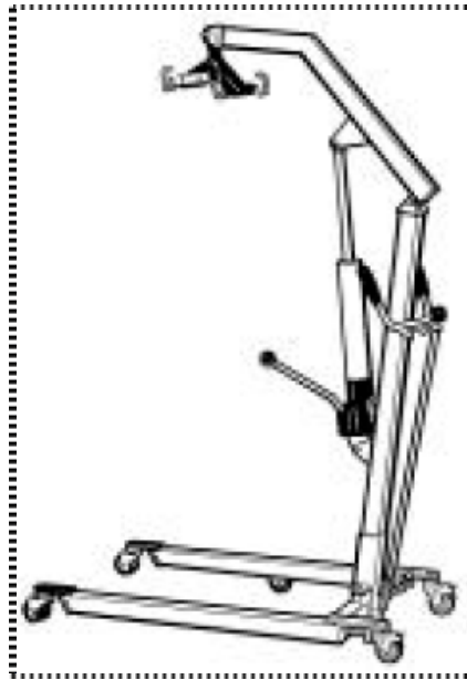
شکل ۳-۹ مکانیزم دستی ( پمپ کنترل هیدرولیک ) (۴)
