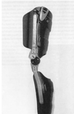
شکل ۴-۵۳- سیستم swing phase lock؛ مکانیزم داخلی این مفصل قبل از اینشیال کونتکت، هنگامی که زانو در اکستنشن کامل است، قفل شده و در پایان مرحله استنس آزاد می‌گردد. این مفصل در بار خارجی ارتز نصب می‌گردد، (۷)
